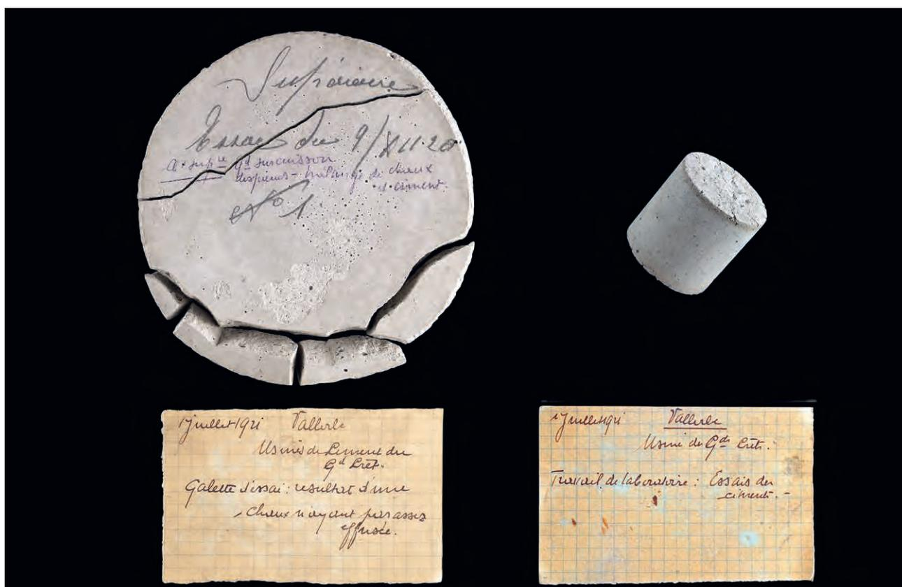
Figure 9. (gauche) : Galette de chaux hydraulique de qualité supérieure utilisée pour des essais à l'usine des Grands-Crêts près de Vallorbe le 9 décembre 1920. Collection Musée cantonal de géologie n°094180. (droite) : Eprouvette de ciment utilisée pour des essais à l'usine des Grands-Crêts près de Vallorbe, 1<sup>er</sup> juillet 1921. Collection Musée cantonal de géologie n°094181. Photographies Stefan Ansermet.
