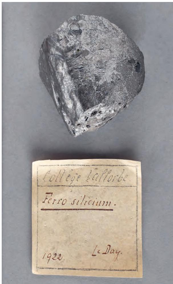
Figure 22. Fragment de ferrosilicium produit à l'usine du Day. Disposant d'énergie électrique en abondance, cette usine a procédé à l'électrolyse des saumures en chlorate ainsi qu'à la fonte de métaux et à la production d'alliages spéciaux. Photographie Stefan Ansermet. Musée cantonal de géologie n° 094172 ; 50 x 40 mm.
