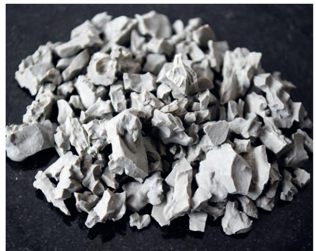
Figure 7. Bentonite de Bois-Genoud. A noter la désagrégation de la bentonite en petits éléments d'environ 1 cm, à surface lisse conchoïdale suite à son séchage, conséquence d'un très important retrait au séchage. Photographie Th. Mumenthaler.
