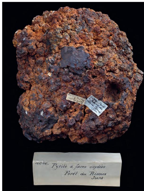
Figure 14. Minerai de fer granulaire constitué de cristaux de pyrite oxydée en limonite. Ce type de minerai, unique dans le canton de Vaud, a été anciennement exploité dans les Mines du Risoux mentionnées dès 1651. 15 x 14 cm. Photographie Stefan Ansermet. Collection Musée cantonal de géologie n°016056.
