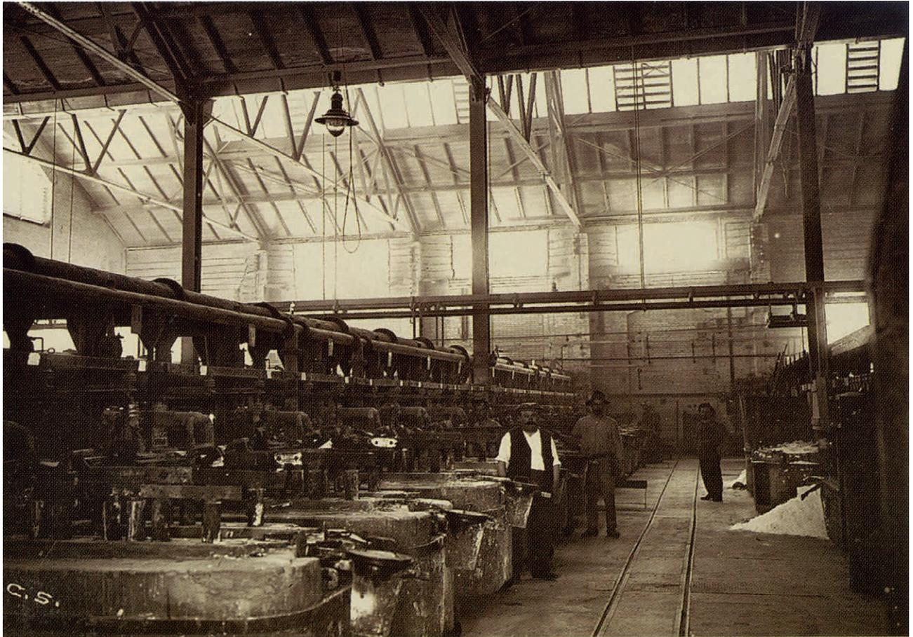
Figure 5. Indispensable à la synthèse de l'indigo, le sodium métallique est produit par électrolyse du sel de Bex fondu dans des fours à 800°C. Pétraradant au contact de l'eau, ce métal sera à l'origine de nombreuses farces entre les ouvriers. Pour la fabrication de l'indigo les ouvriers spécialisés dans l'emploi du sodium métallique étaient respectueusement appelés les « canonniers ». Archives Ciba.
