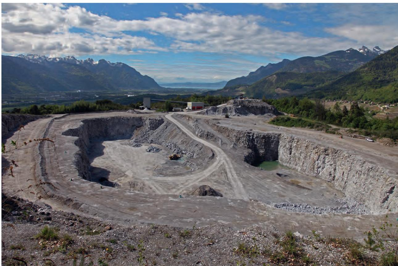
Figure 4. Carrière de gypse ( $\text{CaSO}_4 \cdot 2\text{H}_2\text{O}$ ) du Montet, Bex. Du gypse pour le plâtre, des minéraux des évaporites (anhydrite, ammoniojarosite, bassanite). Photographie S. Ansermet.
