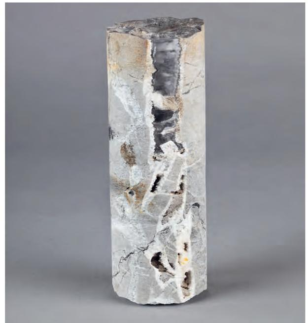
Figure 2. Carotte de sondage de « roc salé » extraite en 1998 à partir de la galerie de l'Espace dans la mine du Bouillet à Bex. Le sondage a percé le minerai de sel à -453 m dissolvant en partie ce dernier. 190 x 48 mm. Photographie Stefan Ansermet. Musée cantonal de géologie n° 065611.
