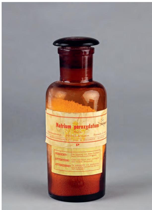
Figure 10. Flacon de peroxyde de sodium en perles et synthétisé par la combustion contrôlée du sodium métallique dans un fort excès d'oxygène. La préparation de cette substance, très utilisée comme décolorant dans l'industrie textile, a permis de trouver un débouché à la surproduction de sodium métallique issu du sel de Bex lors de la première moitié du XX<sup>e</sup> siècle. Photographie Stefan Ansermet. Musée cantonal de géologie n° 094140 ; 185 x 65 mm.
