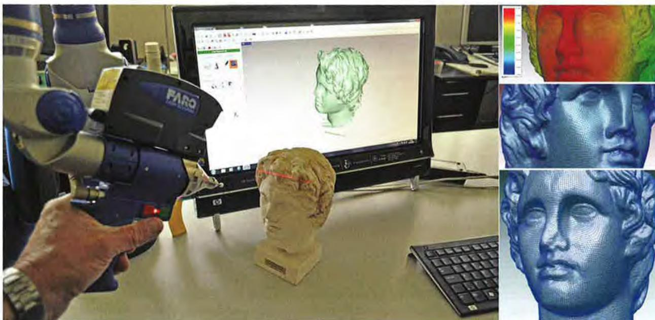
Figure 11.—Numérisation de la tête d'Alexandre avec le capteur de métrologie Faro Arm Platinum et la tête laser Line Probe III; le modèle 3D se constitue en temps réel sur l'ordinateur de contrôle.
