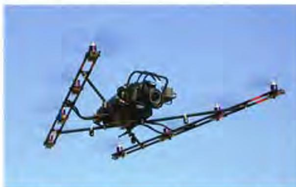
Figure 3.—Les drones permettent la documentation robotisée des zones inaccessibles. Ils ne pèsent que quelques kilos et embarquent des caméras de haute définition (RGB, UV ou IR).
