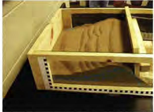
Figure 1. – Bac à sable pour simuler la formation de plis.
