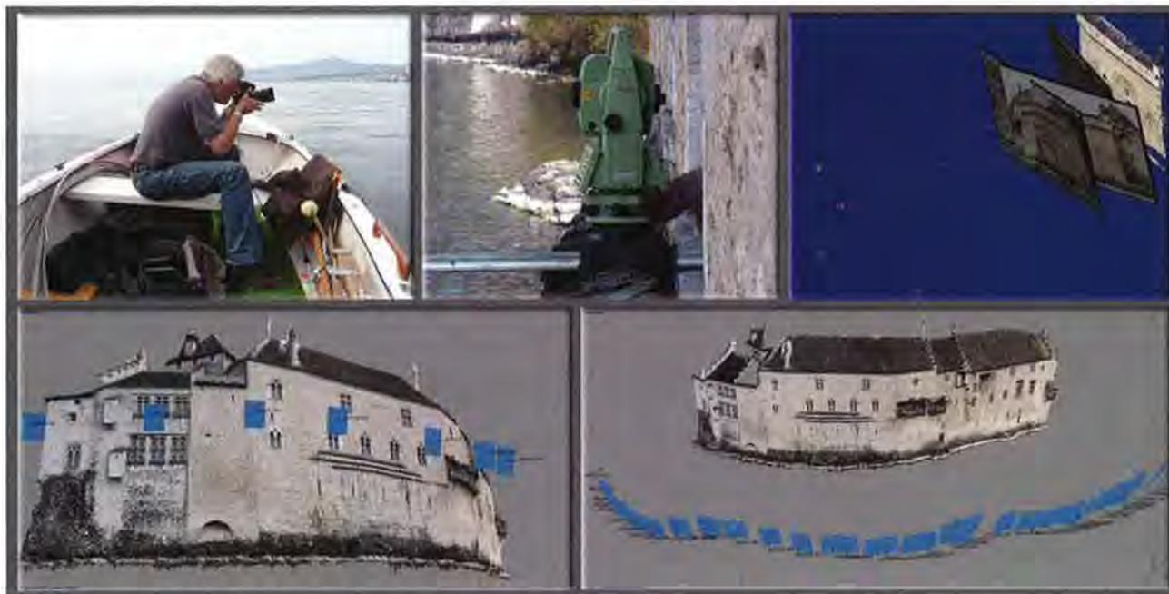
Figure 4.—Façades «côté lac» du château de Chillon; en haut: prises de vue depuis une barque, station robotisée de mesure des points de calage et orientation relative des différents clichés; en bas: représentations du modèle 3D obtenu à partir des photographies dont les points de vue sont indiqués par des rectangles bleus.
