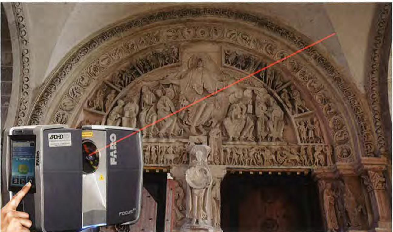
Figure 7.—Le scanner à moyenne portée Faro Focus 3D intègre tous les capteurs et logiciels dans un boîtier de moins de 6 kilos.
