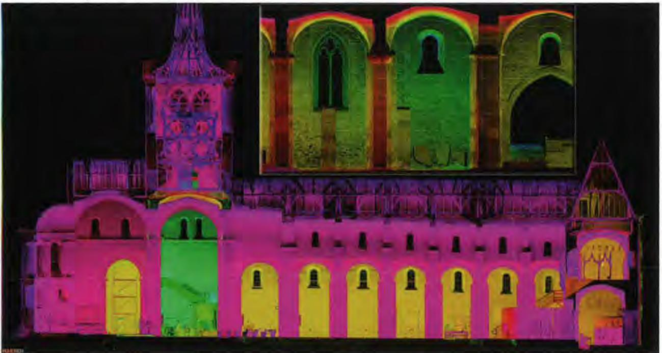
Figure 12.–Abbatiale de Payerne, orthoplan laser de la coupe longitudinale. La colorisation des pixels exprime leur éloignement par rapport au plan de coupe. Le médaillon montre le niveau de détail atteint dans la représentation de la structure du parement numérisé.
